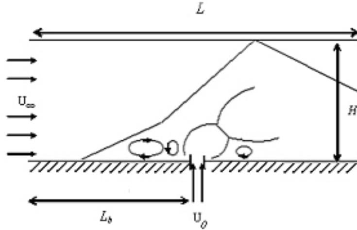
Рис. 1: Схема течения.  $L$  – длина канала,  $H$  – высота канала,  $L_0$  – расстояние от входа потока до щели,  $U_\infty$  – скорость потока,  $U_0$  – скорость струи
