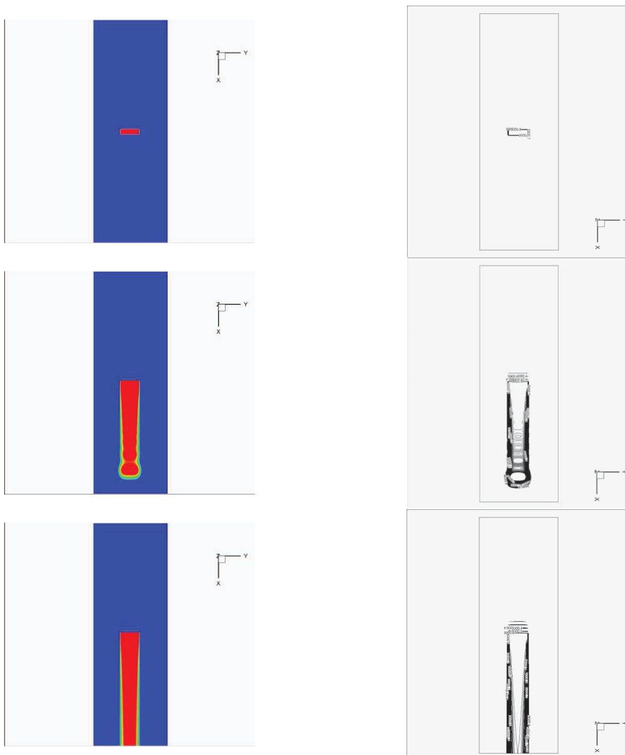
Рисунок 2 – Контур и изолиния распределения температуры при различных безразмерных временных слоях ((a) t=0 , (b) t=5 , (c) t=10 ) в прямоугольном плазменном реакторе размером 0,2 Н.
