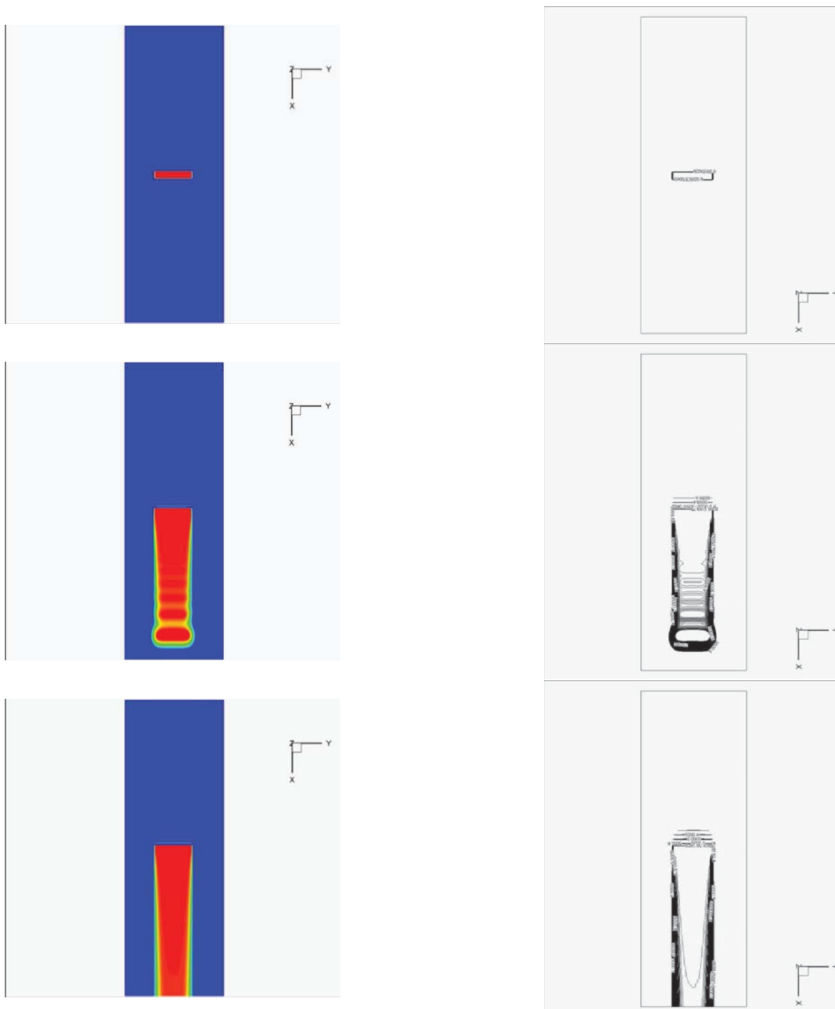
Рисунок 3 – Контур и изолиния распределения температуры при различных обезразмерных временных слоях ((a) t=0 , (b) t=5 , (c) t=10 ) в прямоточном плазменном реакторе размером 0,3 Н.
